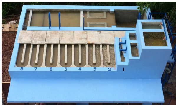
รูปที่ 67 ตำแหน่งการเกิดตะกอนรวมที่ ช่อง 2-3 (อัตราการผลิต 5 ลบ.ม./ชม.)
