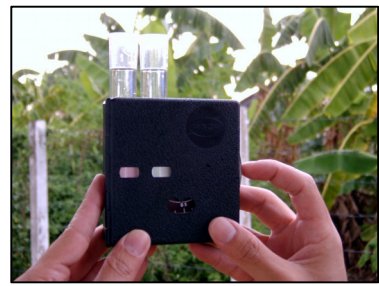
ยกกล่องขึ้นส่องไปทางด้านที่มีแสงสว่าง ค่อยๆ หมุนจานเทียบสีไปรอบๆ ดูที่หลอดทั้งสองหลอดจนกว่าสีจะเหมือนกัน จากนั้นอ่านค่าบนแผ่นจานเทียบสี ตรงช่องมองบนฝากล่องด้านบน จะได้ค่าปริมาณคลอรีนหลงเหลือ มีหน่วยเป็น มิลลิกรัมต่อลิตร
