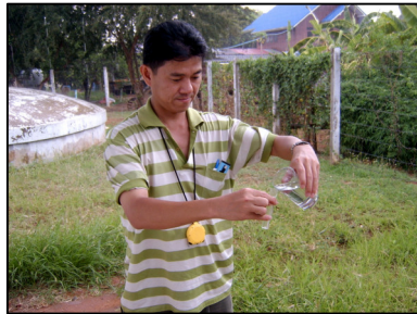
ใส่ตัวอย่างน้ำลงในหลอดกลม ทั้งสองหลอดให้พอดีขีดที่กำหนด
