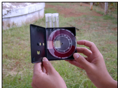
นำหลอดน้ำทั้งสองหลอดใส่ลงในกล่องเทียบสี โดยให้หลอดที่ใส่สารเคมีอยู่ในช่องด้านขวา และอีกหลอดอยู่ในช่องซ้าย จากนั้นใส่แผ่นเทียบสีลงในกล่อง โดยให้รูตรงกลางสวมเข้ากับแกนของกล่อง แล้วปิดฝาด้านบน
