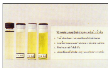
รูปที่ 77 ชุดทดสอบโคลิฟอร์มอิสระคงเหลือในน้ำดื่ม (ว 720 )
