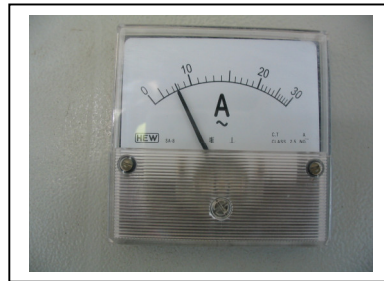
รูปที่ 51 เข็มเครื่องวัดกระแสไฟฟ้าจะต้องแสดงค่ากระแสไฟฟ้าใกล้เคียงกับค่าที่กำหนดในเนมเพลท
